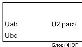
Рисунок 18 – Функциональный блок ФНОП
